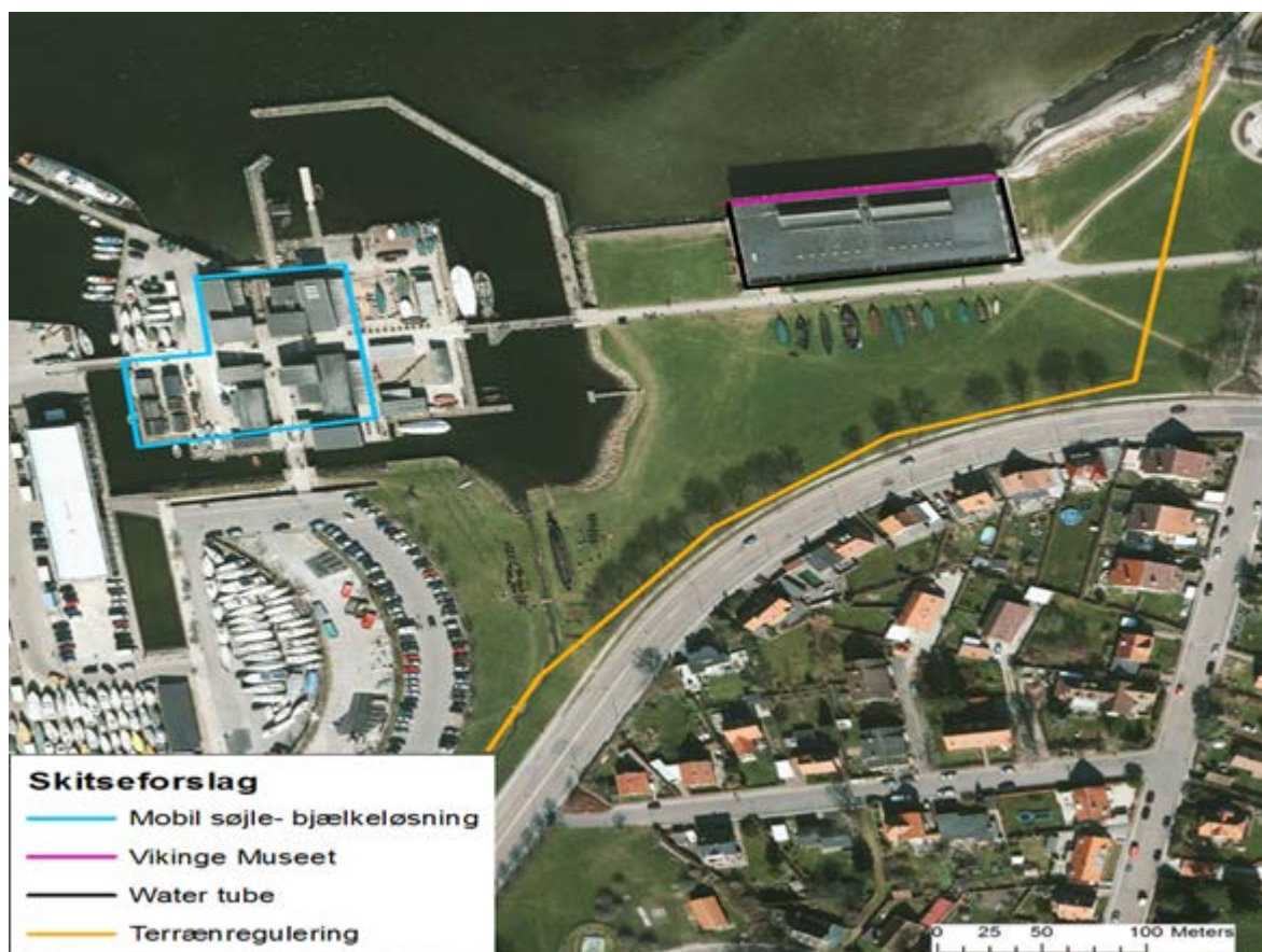
Figur 4.2-1 Skitseforslag til sikring af Museumsøen, dele af Vikingeskibsmuséet og ejendomme på Skt. Claras vej
