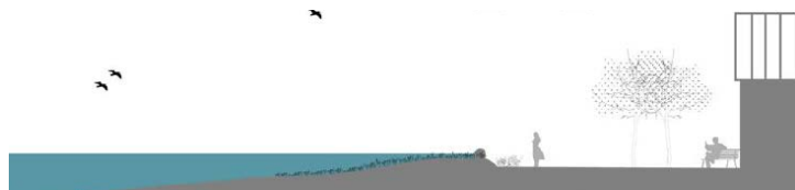
dige med "water tube" - ved høj vandstand
