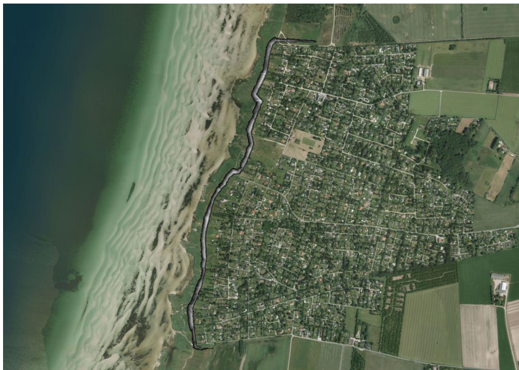
Figur 7-3 Oversigtstegning digets udbredelse med anlæg 1:10 og 1:5. Dråby Strand 2050 (2,99 m DVR90)
