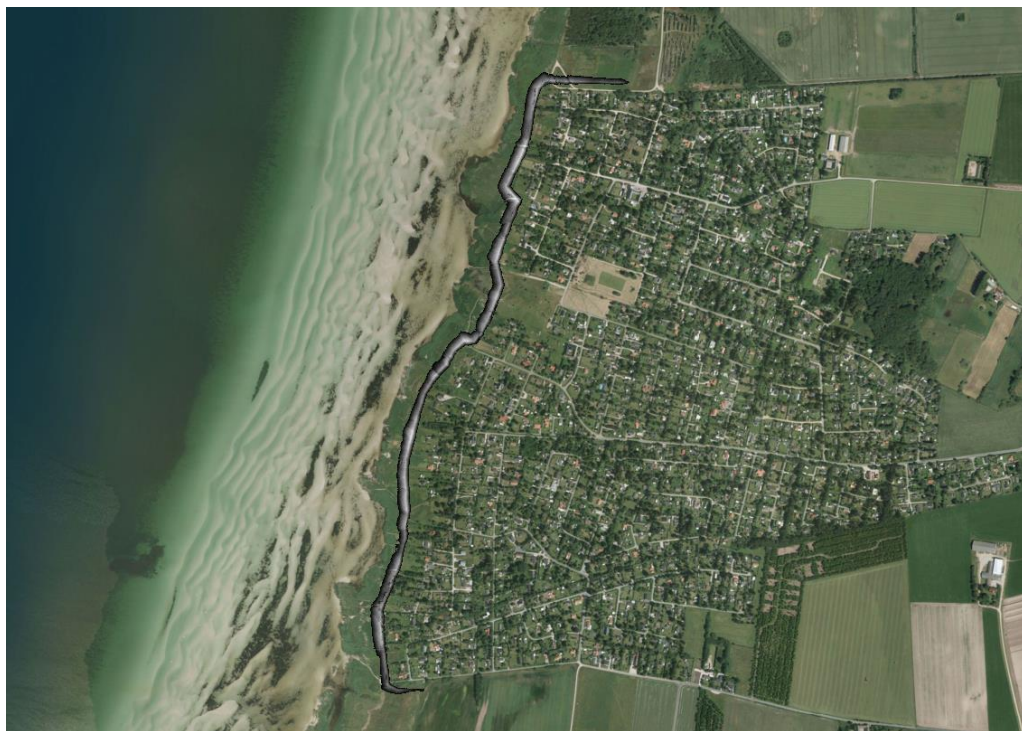
Figur 7-4. Oversigtstegning digets udbredelse med anlæg 1:10 og 1:5. Dråby Strand 2100 (3,15 m DVR90)
