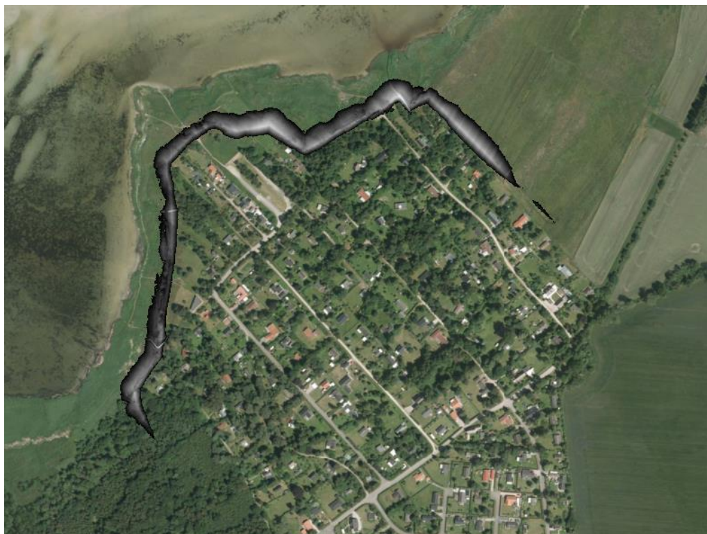
Figur 7-2. Oversigtstegning digets udbredelse med anlæg 1:10 og 1:5. Dalby Huse år 2100, kronekote 3,04 m DVR90
